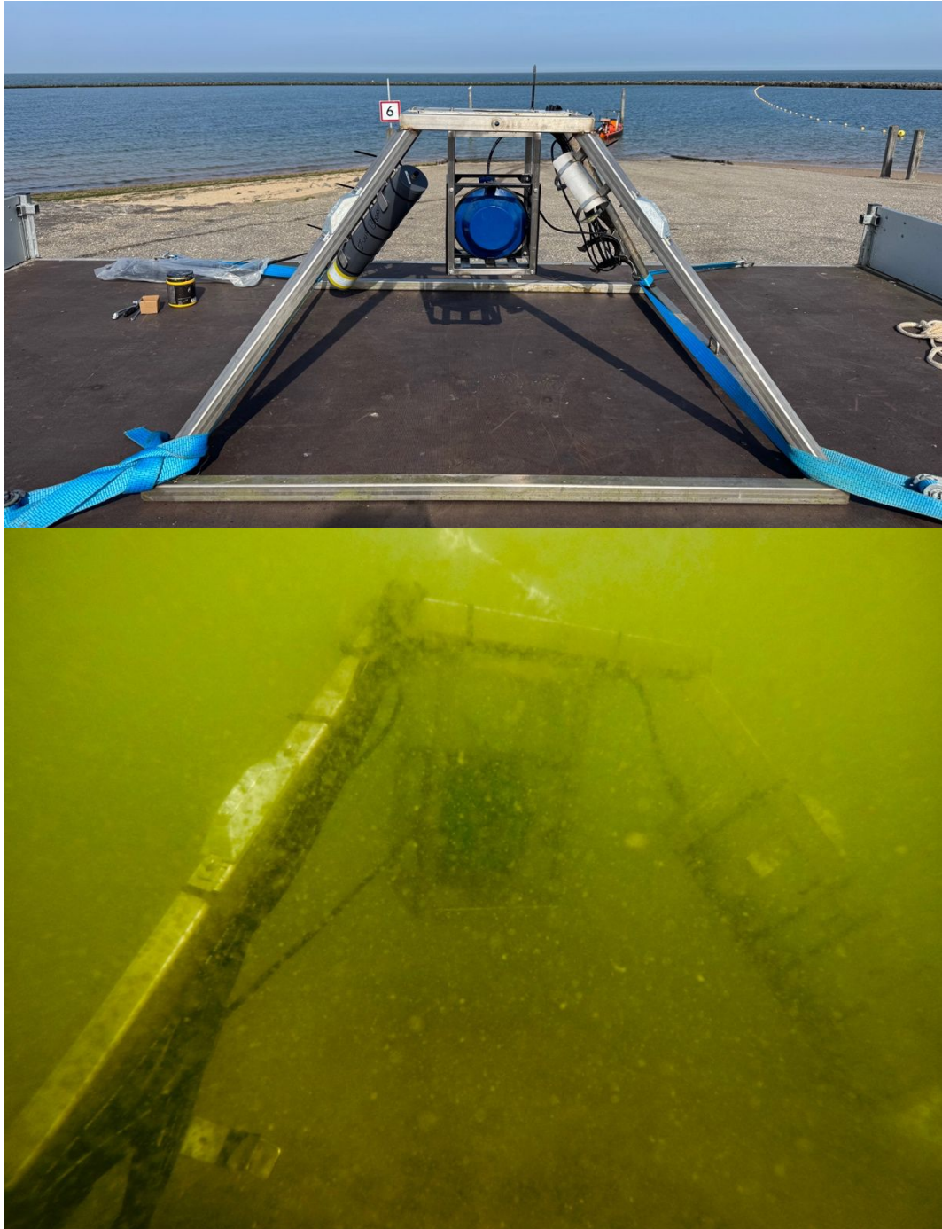
Foto 2.3 Foto impressie. Luidspreker op frame met geluidsdrager en batterij, ten tijde van uitplaatsing (boven), na uitplaatsing (beneden).
