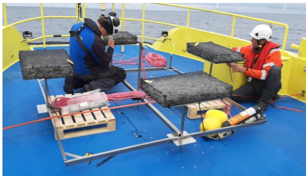
Figuur 1. (A): frame met vier zakken met schelpen. (B) Bovenkant van frame 4, met de acoustic release en een touw, en vier zakken, waarvan twee met oesterschelpen en twee met oesterschelpen behandeld met BESE rifpasta.
