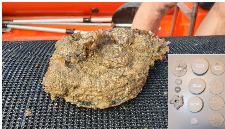
Foto 1. Platte oester op schijf van BESE-reef paste in test fase (links). Testschijven met verschillende samenstellingen van reef paste (rechts).
